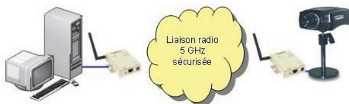
REPLACEMENT D'UN CABLE RJ45 ENTRE DEUX EQUIPEMENTS
