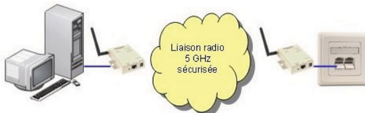
REPLACEMENT D'UN CABLE DE CONNEXION AU RESEAU ENTREPRISE
