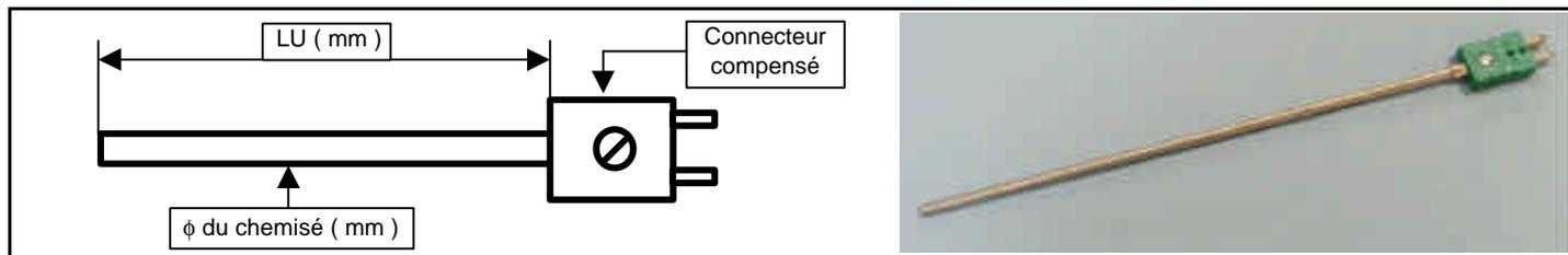
Thermocouple à isolant minéral, chemisé avec une gaine extérieure métallique, à déformation aisée.
