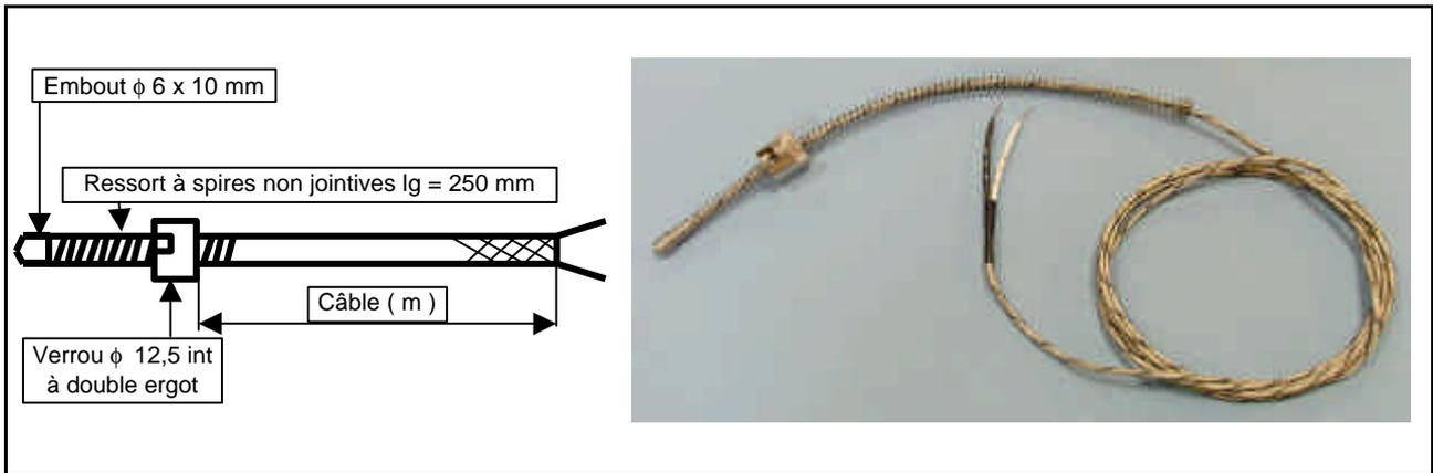
Destiné en particulier à l'industrie du plastique , ce capteur de T° à **thermocouple J ( fe - co )** est équipé d'un système à baïonnette réglable permettant diverses profondeurs d'immersion et l'ajustement de la pression du point chaud .
