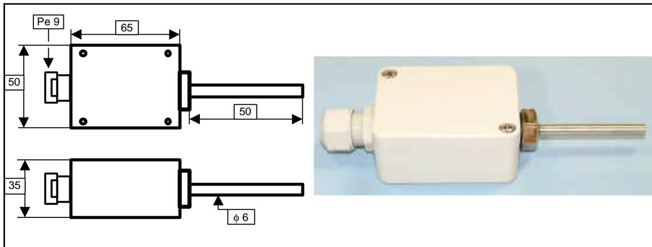
L'ensemble est constitué d'une gaine en acier inoxydable et d'un boîtier en ABS étanche IP 67 avec sortie par Pe 9 .
