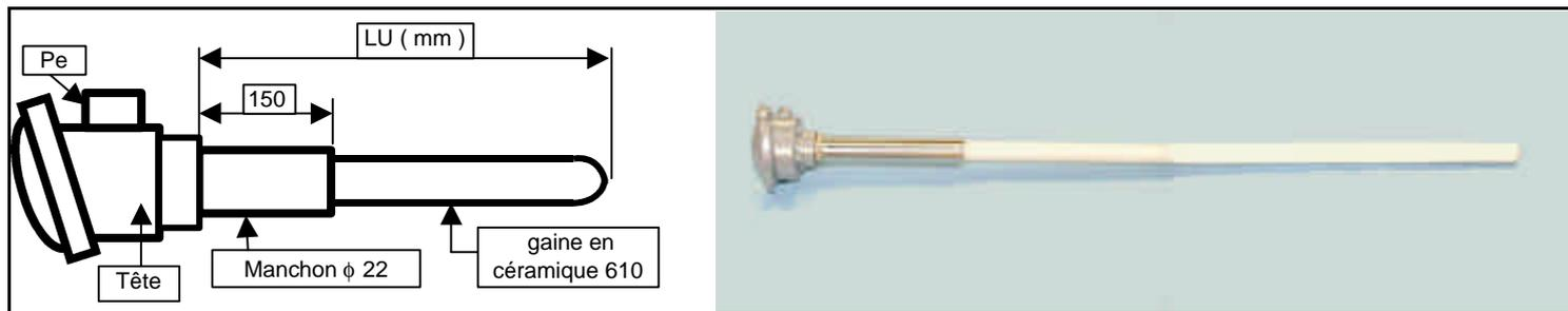
L'ensemble est constitué d'un *thermocouple type K (nicr-nia)*, emperlé sous isolateurs en céramique 610 avec une sortie par *tête alu IP 54, type B*.
