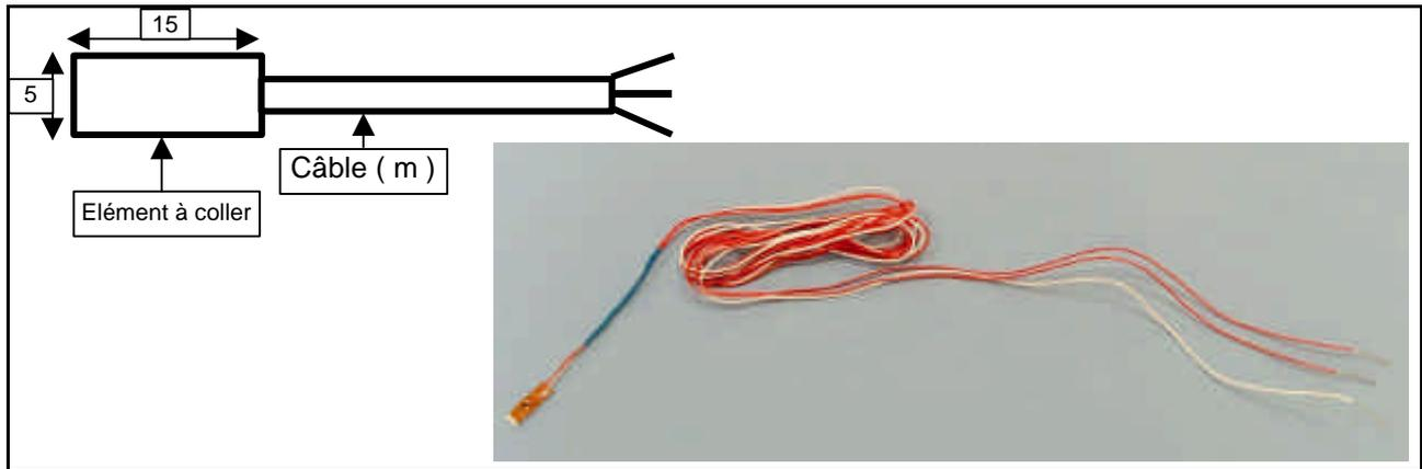
Pour la mesure de T° de surface , un élément de détection est monté dans un film en Kapton .
