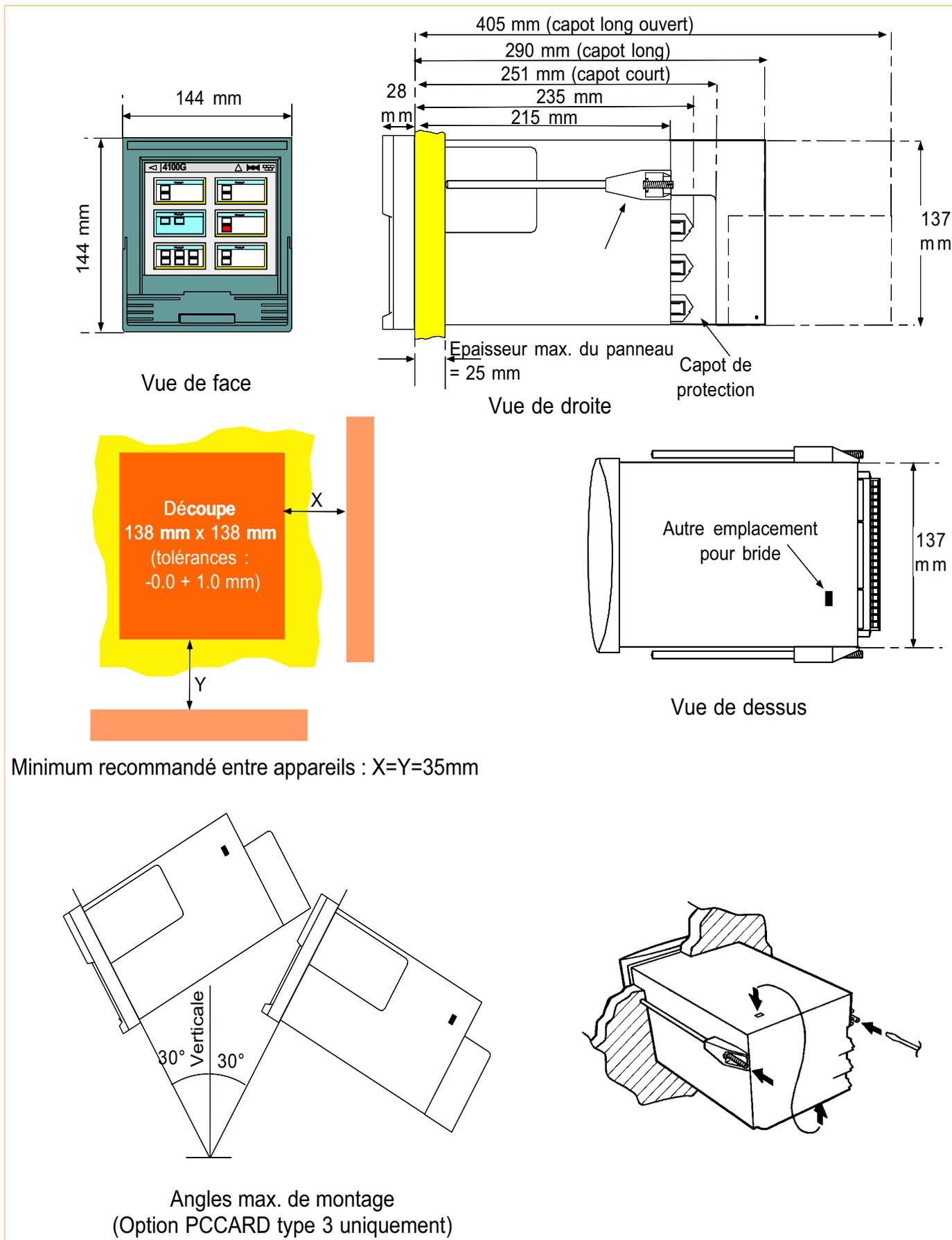
Figure 1.2.1 Installation mécanique
