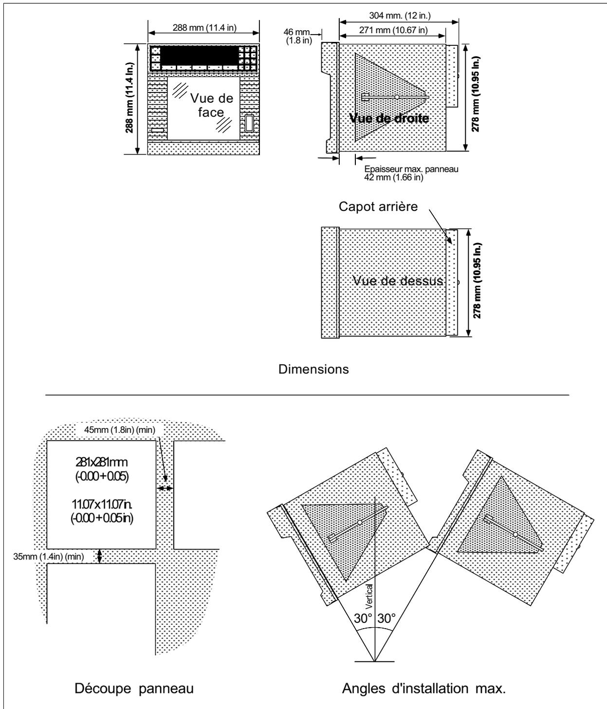
Figure 1.3 Installation mécanique
