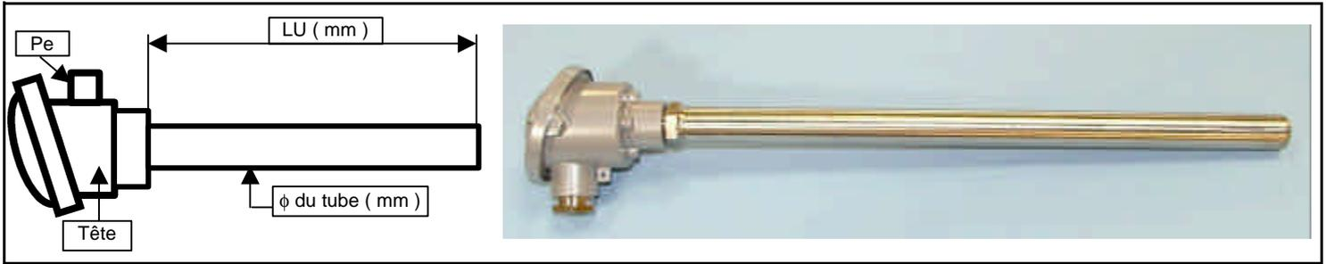
L'ensemble est constitué d'un *thermocouple type K (nicr-nia)* , emperlé sous isolateurs céramique 610 avec sortie par *tête alu IP 54 type B* .
