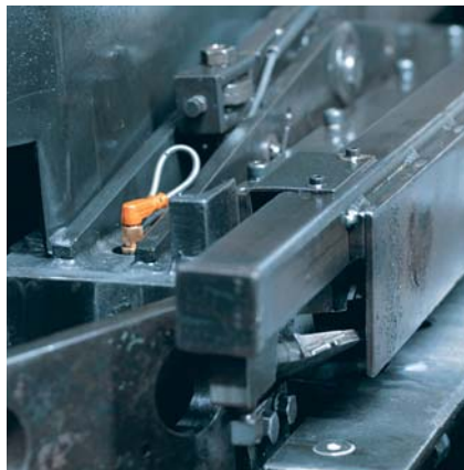
Surveillance du réducteur dans le laminoir à froid.
