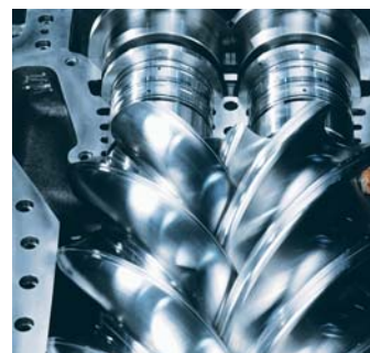
Surveillance des compresseurs à vis.
