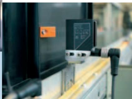
Le TAG peut être monté sur des caisses ou des palettes – via un boîtier support triangulaire ou en l'intégrant directement sous la forme d'une vis sans tête M5.
