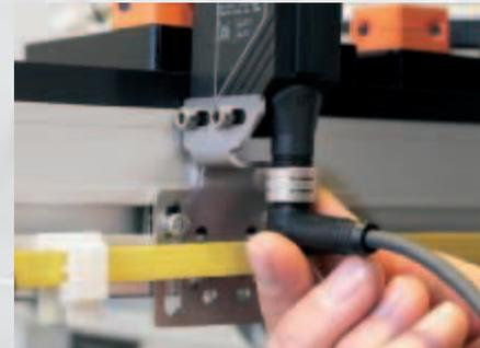
La tension est fournie par le réseau AS-i via un connecteur M12 orientable. Pas de tension supplémentaire nécessaire.
