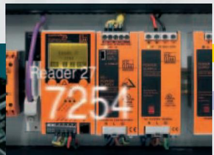
Pour la lecture / écriture, le système d'identification RFID utilise le protocole analogique AS-i 7.4 pour le transfert de données. Aucun logiciel spécial n'est nécessaire.
