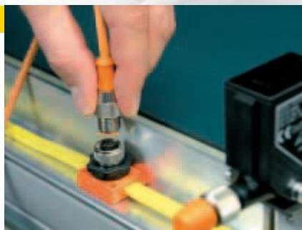
Raccordement par connecteur M12. La connectique AS-i habituelle peut être utilisée, par exemple: répartiteur passif câble plat / connecteur M12. Pas de programmation supplémentaire requise.
