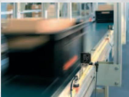
Jusqu'à 31 têtes de lecture/écriture peuvent être raccordées sur un maître AS-interface. Le code de 15 bits de chaque tête est lu en dynamique avec des vitesses de passage pouvant aller jusqu'à 0,5 m / s.
