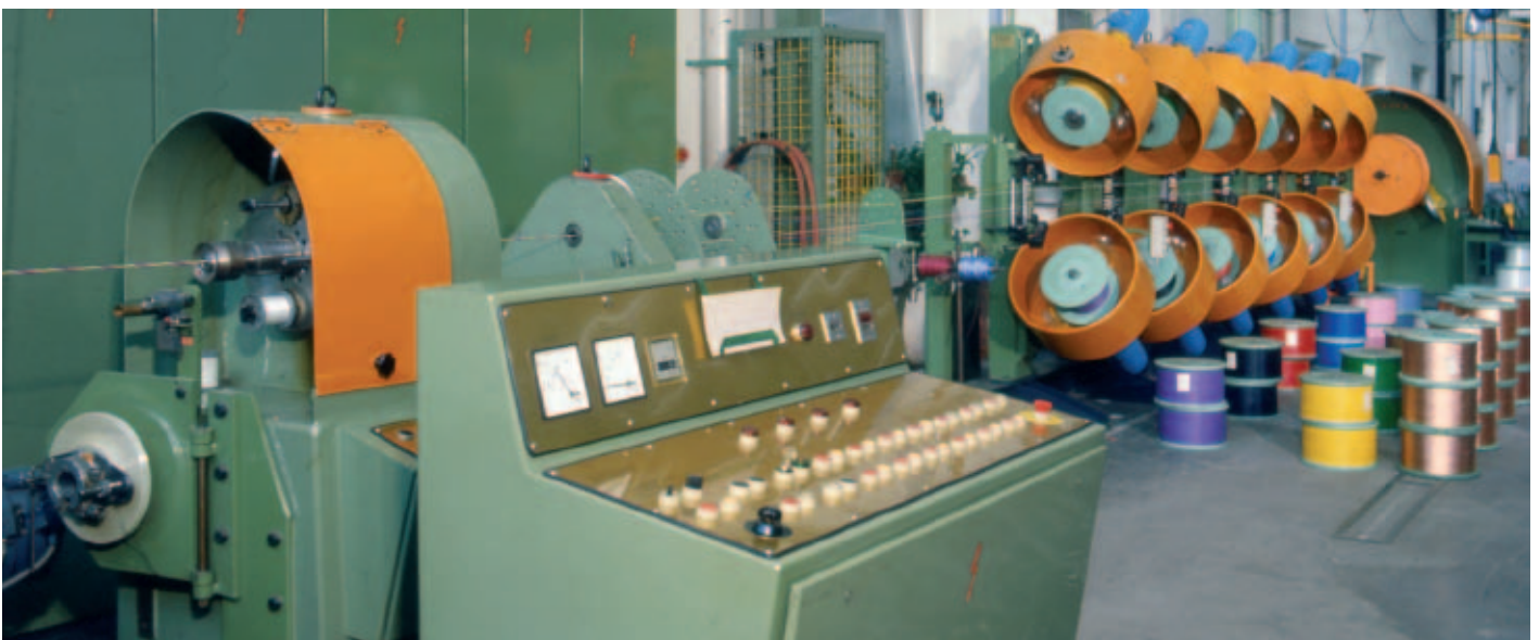
Machine à torsader les petits câbles flexibles
