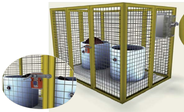
Contrôle de l'accès à la zone dangereuse par une serrure d'accès type NXOL
