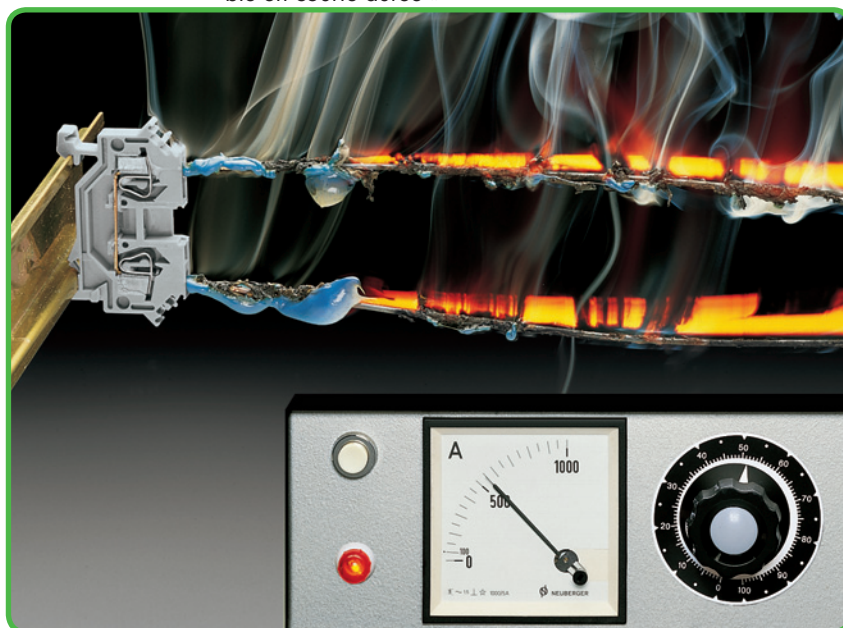
Montage du test « valeur crête de l'intensité admissible en courte durée »
