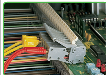
Tester avec un adaptateur de test.
