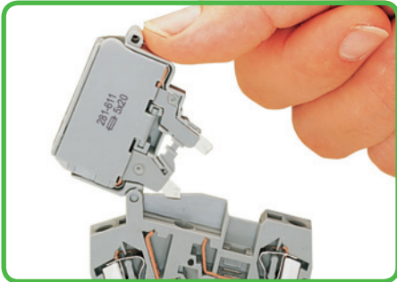
Avant de remplacer le fusible, faire pivoter le porte-fusible vers le haut jusqu'au cran d'arrêt
