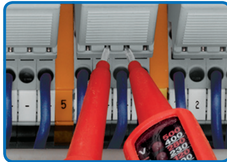
Tester le fonctionnement par simple contact protégé.
