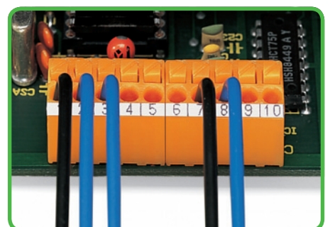
Juxtaposition de blocs de bornes sans perte d'écartement polaire.
