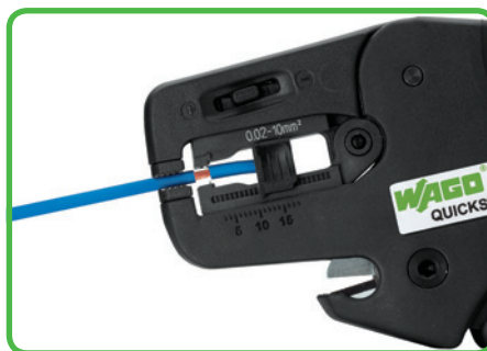
Quickstrip 16. Dénuder le conducteur.
