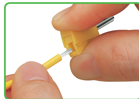
Raccordement du conducteur : presser le boîtier de chaque côté de l'ouverture rectangulaire et introduire le conducteur
