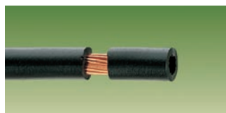
Le dénudage partiel
