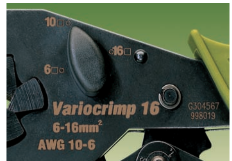
Seulement pour Variocrimp 16: Réglage de la section du conducteur à pince ouverte.
