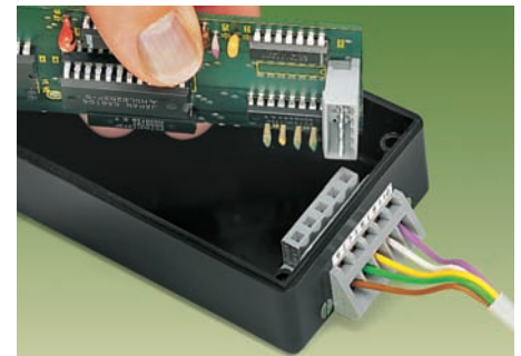
Connecteur femelle coudé utilisé comme connexion traversante de cloison. Ouvertures d'introduction des conducteurs et de manipulation à l'extérieur du boîtier. Épaisseur de la paroi du boîtier jusqu'à 2 mm.
