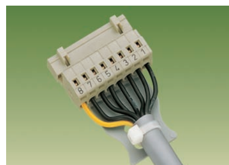
Connecteur mâle, pas 5 mm, gris clair, 8 pôles, avec impression directe et plaque de décharge de traction 721-608/000-044/034-000
