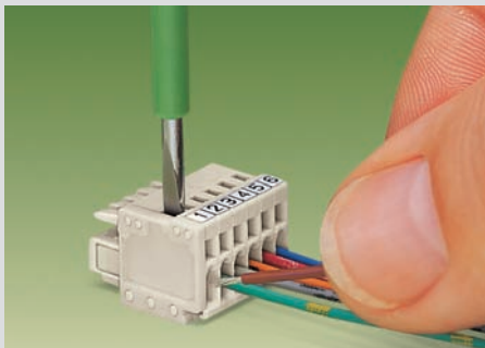
Raccordement des conducteurs – câblage latéral – avec un tournevis (2,5 x 0,4) mm
