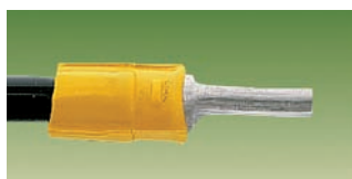
Ou clips isolés (sertis de manière étanche aux gaz), de préférence en cuivre à surface étamée en bain.
