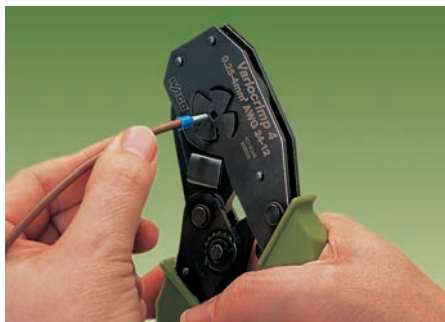
Introduire le conducteur muni de l'embout d'extrémité dans la station de sertissage
