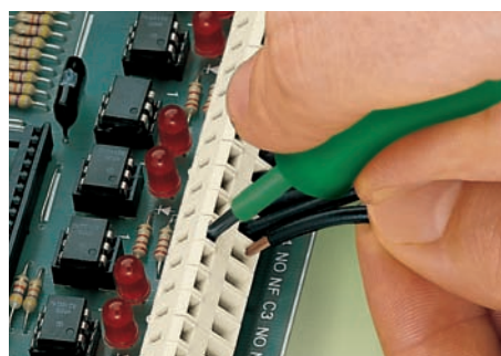
Raccordement du conducteur à l'aide d'un tournevis de 3,5 mm. Actionnement et introduction du conducteur par la même direction, série 236.
