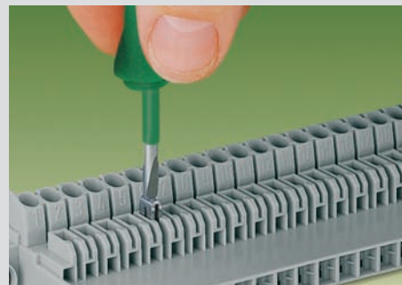
Pontage avec contacts de pontage horizontaux. Pousser les contacts à fond.
