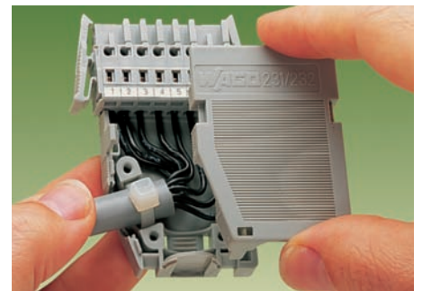
Encliquetage de la partie supérieure de la décharge de traction sur un connecteur femelle avec cliquets de verrouillage. Sortie de câble latérale. Décharge de traction par collier pour câbles (jusqu'à une largeur de 4 mm).
