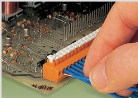
Raccordement des conducteurs par enfichage direct sur bornes avec poussoir
