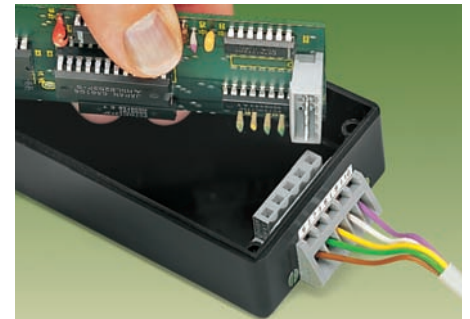
Connecteur femelle coudé utilisé comme connexion traversante de doison. Ouvertures d'introduction des conducteurs et de manipulation à l'extérieur du boîtier. Epaisseur de la paroi du boîtier jusqu'à 2 mm. La photo montre un connecteur d'un pas de 5 mm.
