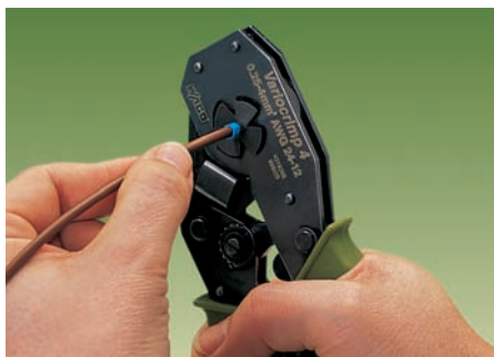
Presser ensemble les deux poignées jusqu'à ce que le cran de verrouillage, empêchant une ouverture prématurée, se débloque.
