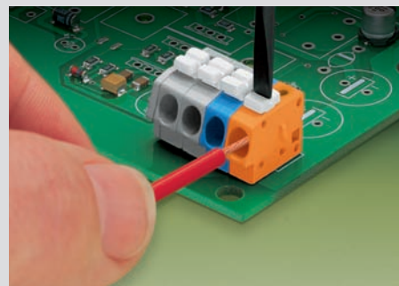
connexion/déconnexion des conducteurs souples : Ouvrir le point de serrage à l'aide du poussoir et introduire le conducteur dénudé jusqu'à la butée.
