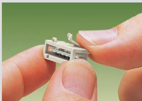
Détrompage d'un connecteur mâle – Encliqueter le(s) détrompeur(s)
