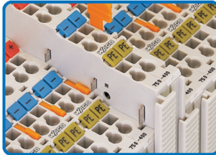
Connexion sûre et automatique par des contacts étamés, autonettoyants et coulissants, avec contact de terre avancé
