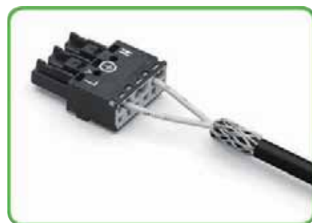
Positionner la tresse de blindage autour de la gaine du câble. Longueur de dégainage = 55 mm Longueur de blindage = 10 mm
