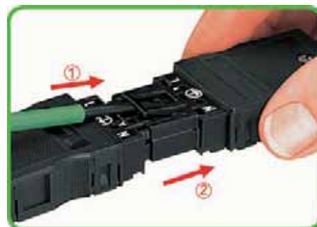
Cliquet de verrouillage à manipuler avec un tournevis : 1.) Soulever le cliquet de verrouillage avec le tournevis. 2.) Séparer les connecteurs. (Exemple : connecteur à 3 pôles)
