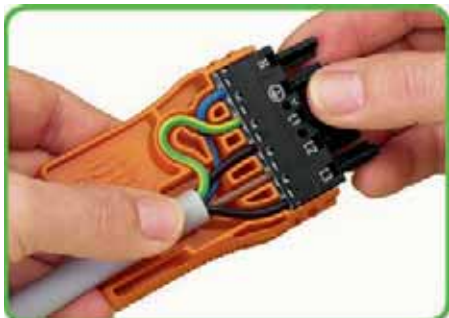
Enficher le connecteur jusqu'à la butée.
