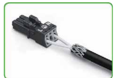
Positionner la tresse de blindage autour de la gaine du câble. Longueur de dégainage = 30 mm Longueur de blindage = 8 mm
