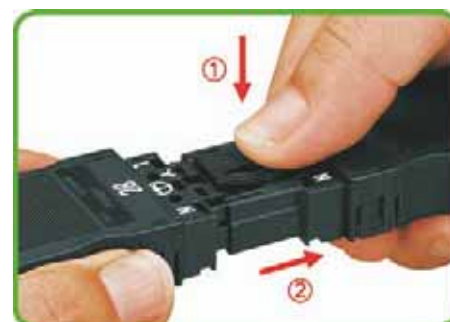
Cliquet de verrouillage à manipuler à la main : 1.) Presser sur cliquet de verrouillage 2.) Séparer les connecteurs.
