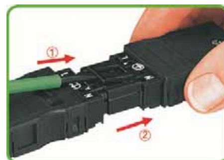
Cliquet de verrouillage à manipuler avec un tournevis : 1.) Soulever le cliquet de verrouillage avec le tournevis. 2.) Séparer les connecteurs.
