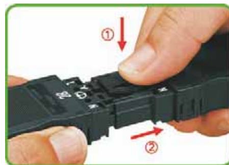
Cliquet de verrouillage à manipuler à la main : 1.) Presser sur cliquet de verrouillage 2.) Séparer les connecteurs. (Exemple : connecteur à 3 pôles)
