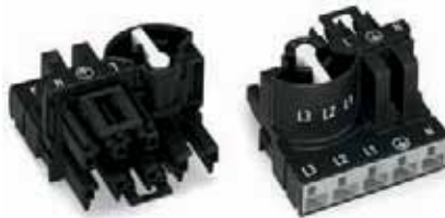
Soulever le sélecteur de phase placé en position d'alimentation L2 à l'aide d'un tournevis de largeur de lame 2,5 mm et le faire pivoter sur la phase désirée.
