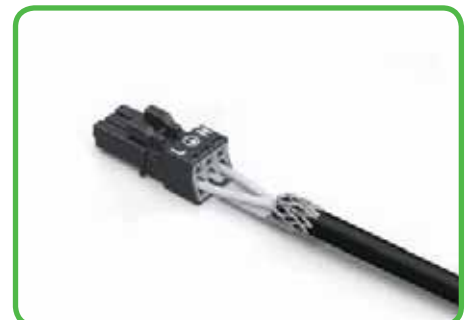
Introduire la reprise de blindage dans le connecteur jusqu'à être en butée.
