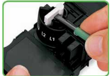
Soulever le sélecteur de phase placé en position d'alimentation L2 à l'aide d'un tournevis de largeur de lame 2,5 mm et le faire pivoter sur la phase désirée.
